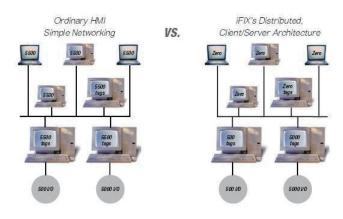
不同於普通一般 HMI/SCADA 套裝軟體設計的簡易系統,若增加工作站時,需要在所有的節點上添加新的節點資訊,而且要在每一節點上複製所有的 Tag 製程資料庫。
