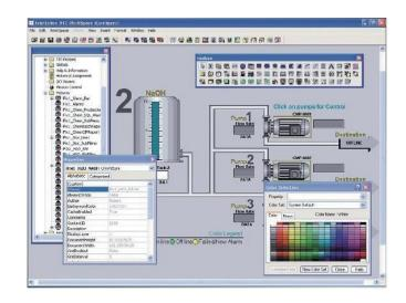
Proficy HMI/SCADA - iFIX WorkSpace 是一強大的物件包容器,提供了易於使用的開發環境。它的特色具有檔案管理員之系統樹狀結構能容易地查詢及管理物件。
